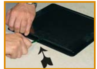
Apertura del coperchio con l'ausilio di un attrezzo. Cover opening by means of a tool.
